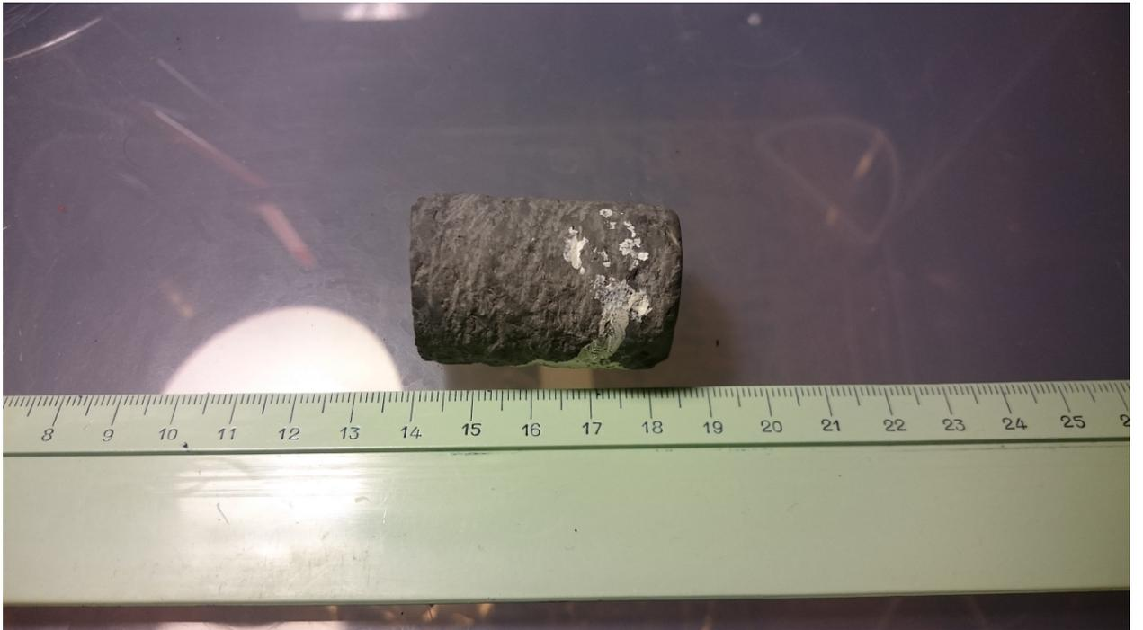
Рисунок 2.6 – Общий вид образца горной породы использованного для анализа методом пиролиза
