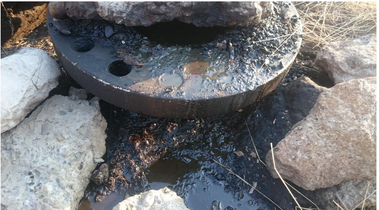
Рисунок 2.7 – Нефтепроявления на устье скважины № 7 Сельской
